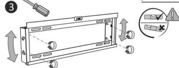
Verifique con el nivel burbuja que el soporte esté perfectamente derecho y ajuste los 4 tornillos tirafondo.
