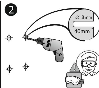
2 Haga las 4 perforaciones en la pared con una mecha de widia de 8mm y coloque los tarugos de 8mm en las mismas. **(Se recomienda hacer un agujero previo con mecha de 6mm).**
