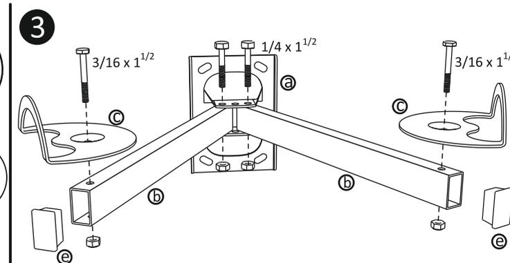
3 Unir las piezas **c** a los extremos con el agujero más chico de los caños **b** utilizando los tornillos  $3/16 \times 1\frac{1}{2}$  y las tuercas de  $3/16$ . Por los extremos del agujero más grande se unen a la pieza **a** utilizando los tornillos de  $1/4 \times 1\frac{1}{2}$  y las tuercas de  $1/4$ . En los extremos de los caños **b** se colocan los tapones plásticos **e**.
