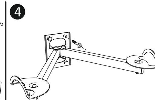
4 Coloque los 4 tirafondos y previo a ajustarlos verifique nuevamente con un nivel burbuja que el soporte quede perfectamente horizontal. Luego como terminación estética, coloque los 4 tapones **f** en cada tirafondo. Por último pegue las bandas protectoras adhesivas.
